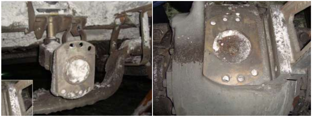
обрыв болтов крепления опоры редуктора пассажирского вагона
