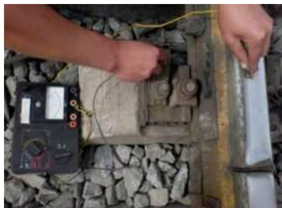
Измерение кронштейн - рельс
