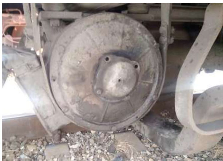
Признаки заклинивания генератора (отсутствие болтов крепительных крышек, следы нагрева, выброса смазки)
