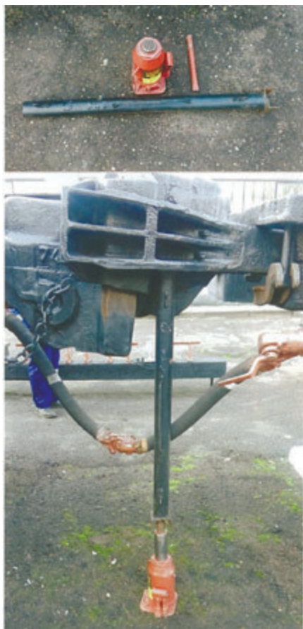
Рис. 12. Приспособление для замены центрирующей балочки и маятниковой подвески
