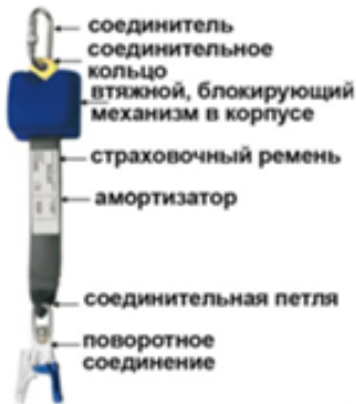
Рис.3. блокирующее устройство с внешним амортизатором
