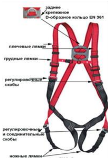
Рис.2. Точка крепления страховочных привязей
