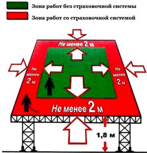
Рис.2 Зоны работ со страховочной привязью
