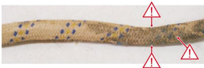
Рис.4. Дефекты диаметра стропа
