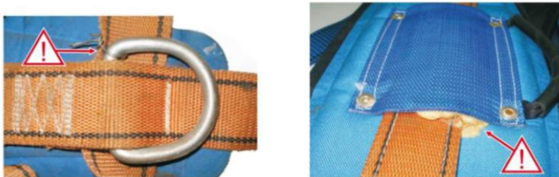
Рис.1. Признаки ремонта привязей
