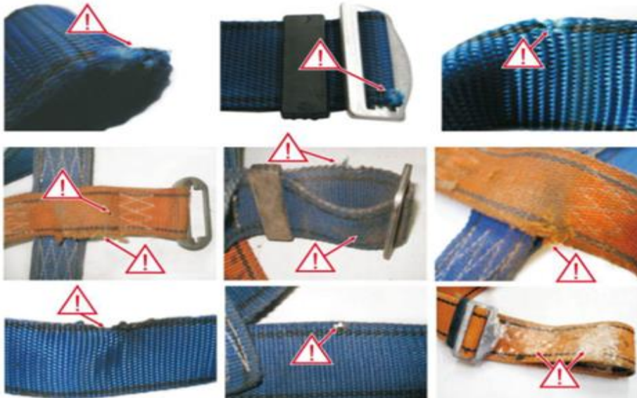
Рис.2. Признаки нарушения состояния лямок
