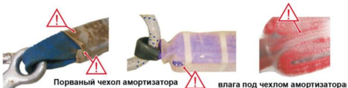
Рис.1. Повреждения чехла амортизатора
