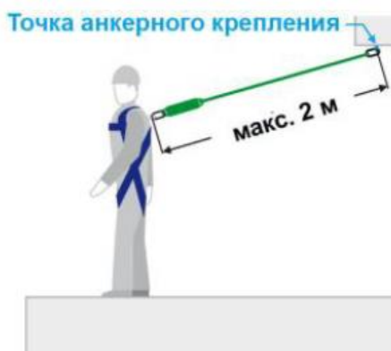
Рис.2. Использование страховочного стропа с амортизатором на стационарной точке
