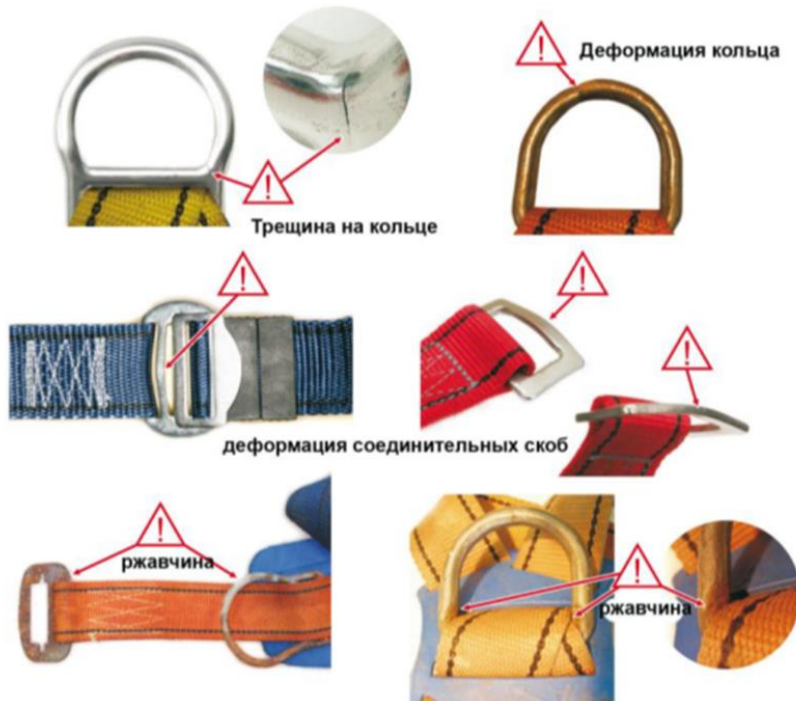
Рис.4. Дефекты скоб, петель, соединительных колец
