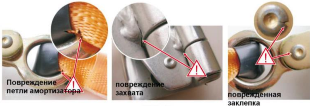
Рис.1. Повреждения текстильных амортизаторов блокирующих устройств
