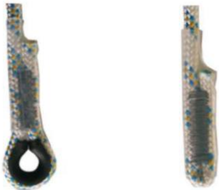
Рис.2. Повреждения ограничителей анкерной линии блокирующего устройства
