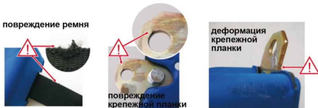
Рис.1. Повреждения компонентов блокирующего устройства инерционного типа
