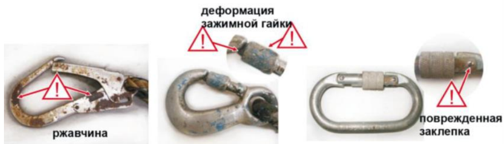
Рис.1. Признаки деформации карабинов
